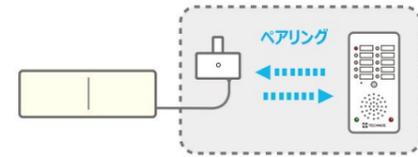
「エリア・グループ設定」より簡単な設定方法です。送信機と受信機のペアリングスイッチを押して、センサーを一度動作させるだけで設定できます。もちろん、混信はありません。
