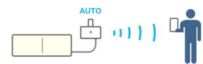
センサーで反応したときに確実に受信機が鳴ることを確かめるには、今まではセンターを作動させると、遠くで受信機を確認する人の2人が必要でした。「テスト送信機能」を使えばこの作業が1人でできます。
