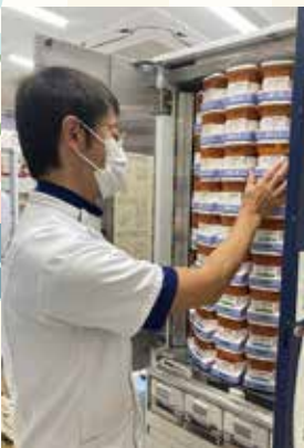
▲全自動錠剤分包機に薬剤を充填しているところ
